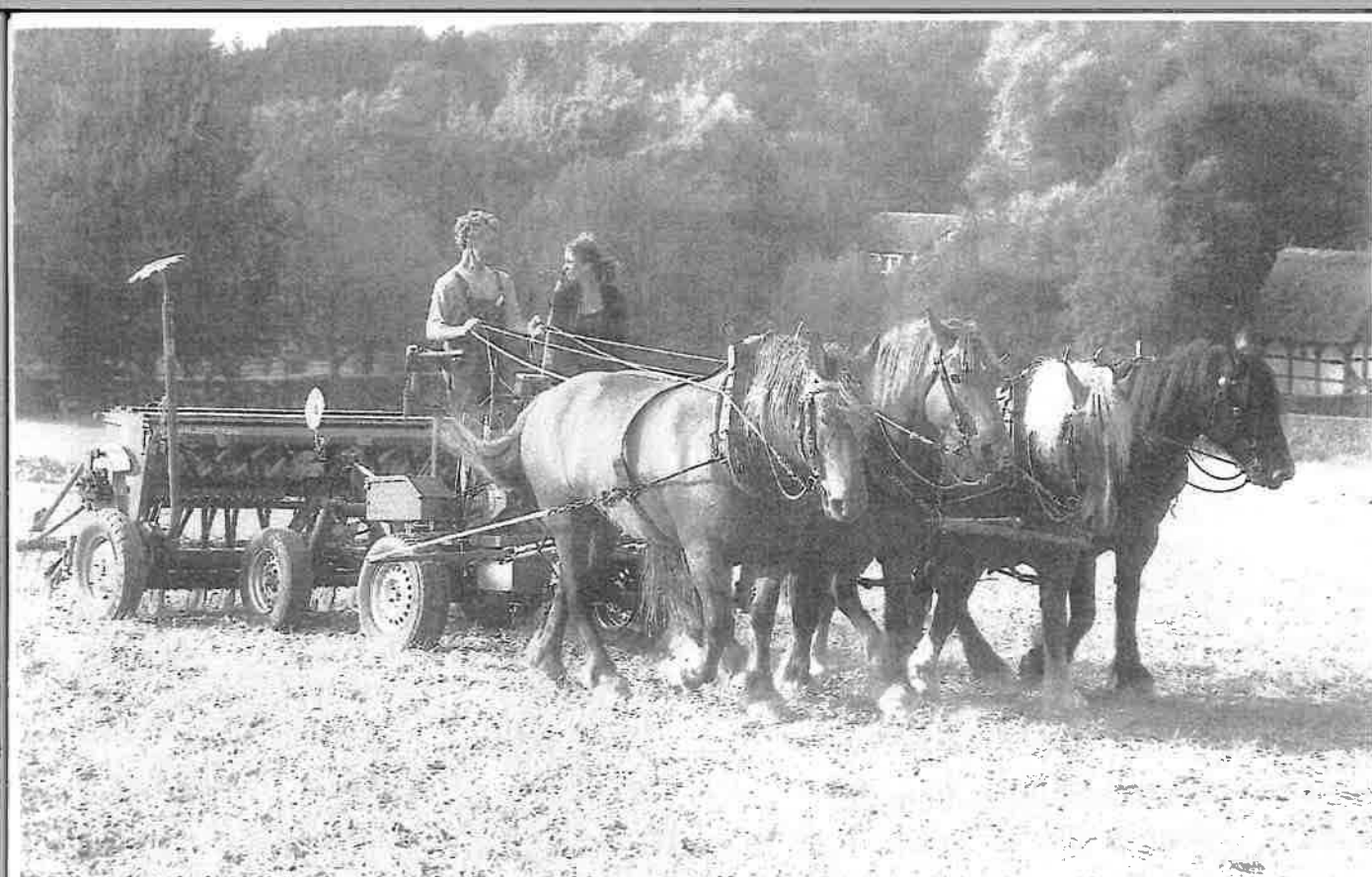
Semoir moderne, conçu pour la traction animale.
