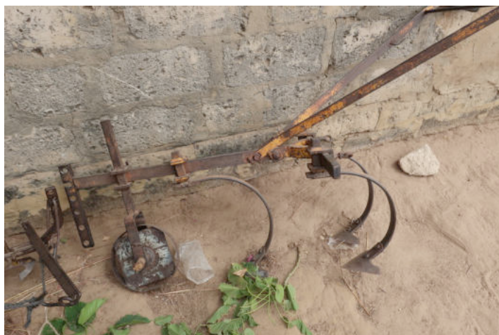
Photo 5 Houe sine avec soc tridents
