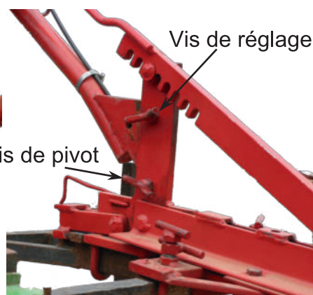
Réglage du guidon sur la kassine V1, vue droite
