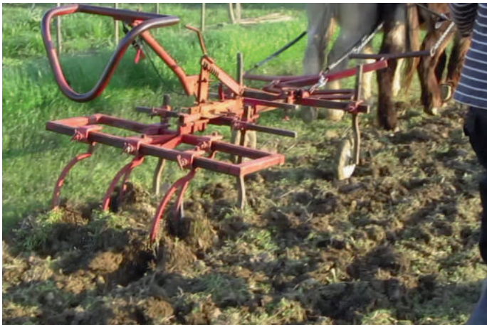
Travail du sol avec dents flexibles et socs côtes de melon
