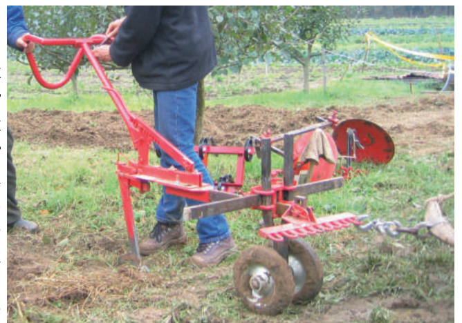
Passage à une roue facilité en rassemblant les deux roues au centre
