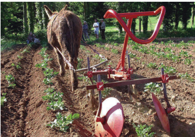
La kassine à 2 roues avec les disques billoneurs ou le cadre cultivateur n'a pas forcément besoin d'être tenue durant le travail.
