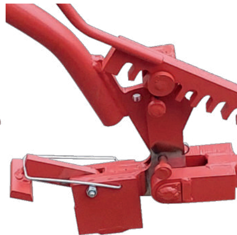
Réglage du guidon sur la kassine V2, vue droite
